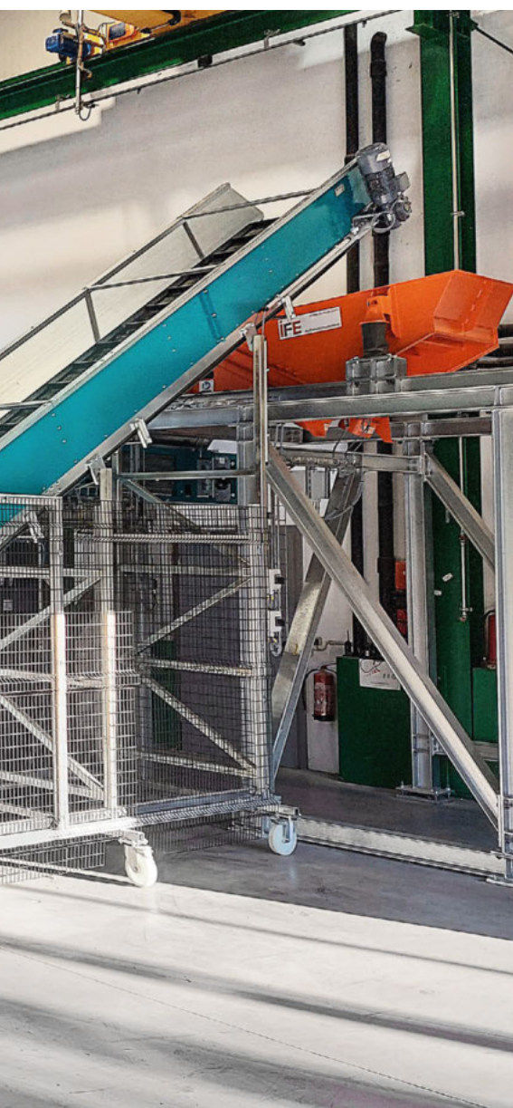
Die Forschungs- und Versuchsanlage im Digital Waste Research Lab der Montanuniversität Leoben kann Abfall analysieren und sortieren.
