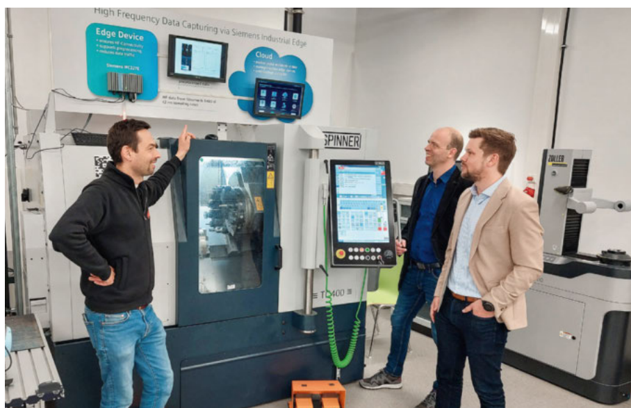
Stefan Trabesinger (li.), TU Graz, erklärt, wie mit Siemens Industrial Edge for Machine Tools die Daten aus der SINUMERIK-Steuerung der Spinner-CNC-Maschine direkt ausgewertet werden können.
