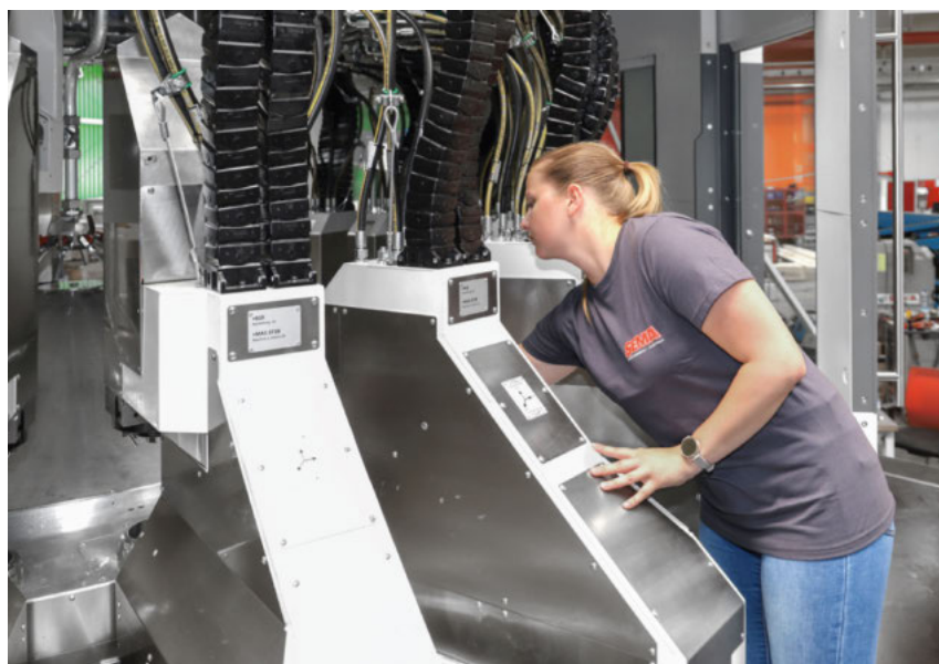
Einfacher Zugang in der 79-CNC-Achsen-Rundtaktanlage trotz kompakter Bauweise.
